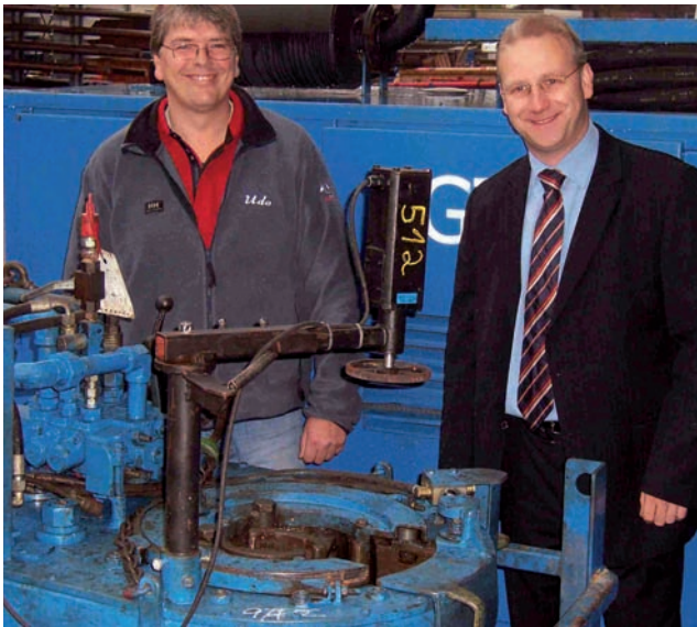
Udo Boerrigter, Geschäftsführer von GTS, und Andreas Frochte, Vertriebsingenieur bei Leine & Linde, hinter der 7 5/8"-Hydraulikzange mit Drehzahlmesser. Sie ist um einen ATEX 632-Drehgeber zentriert.
